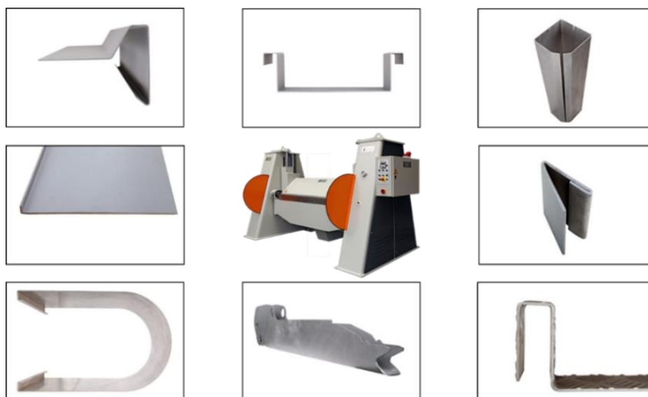
Abb. 3: Fertigungsflexibilität des Schwenkbiegeverfahrens, nach [8]
