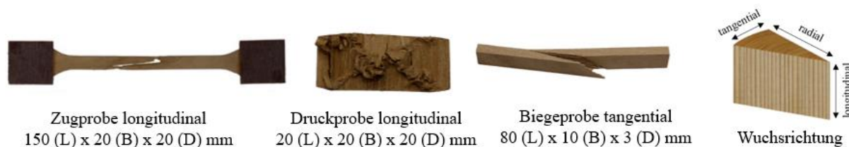
Abb. 2: Testkörper aus Robinienholz zur mechanischen Charakterisierung
