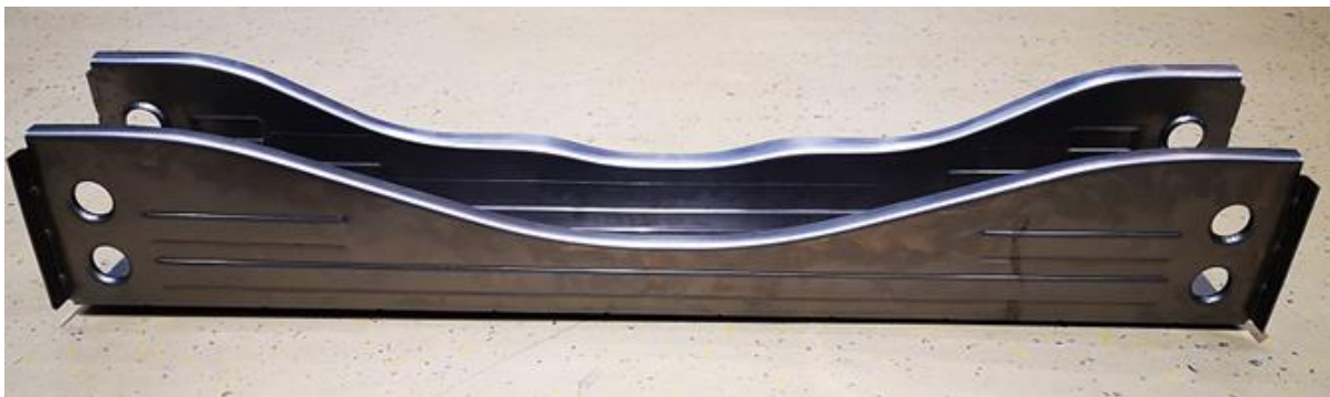
Abb. 10: Finalisierter Querträger 3, welcher ausschließlich mit universell einsetzbaren Werkzeugen gefertigt wurde
