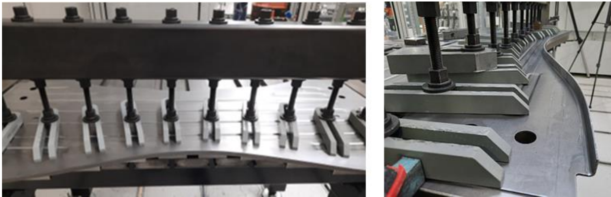
Abb. 9: Bauteil in Spannvorrichtung unmittelbar vor dem roboterbasierten Rollformen (links) sowie fertig rollgeformter Flansch (rechts)
