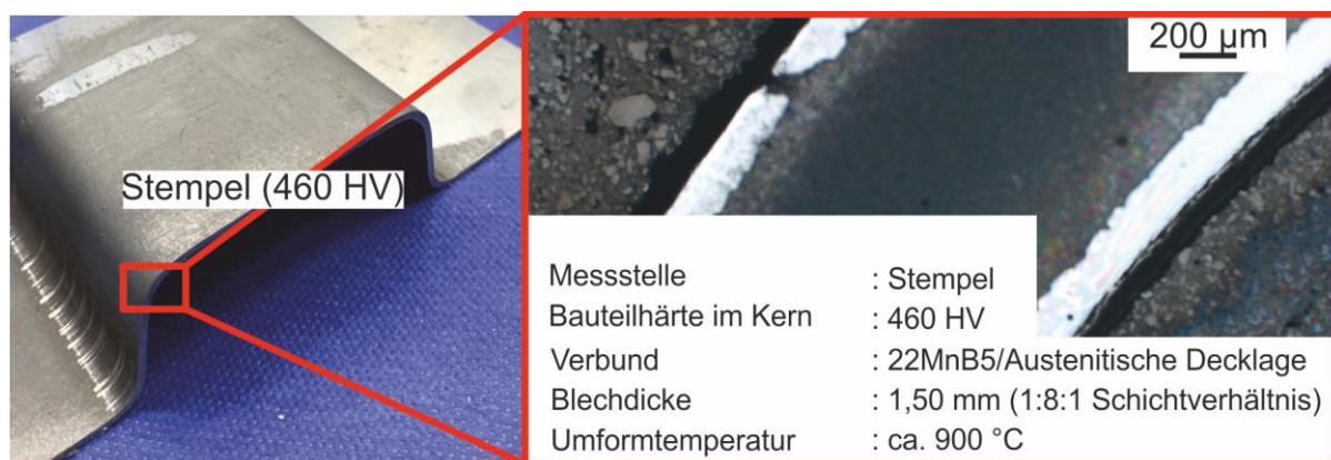
Abb. 8: Anwendung des Verbundes (austenitisch/22MnB5) beim Presshärten eines Hutprofiles
