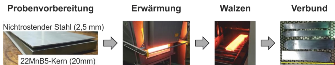
Abb. 4: Herstellung der Verbundwerkstoffe
