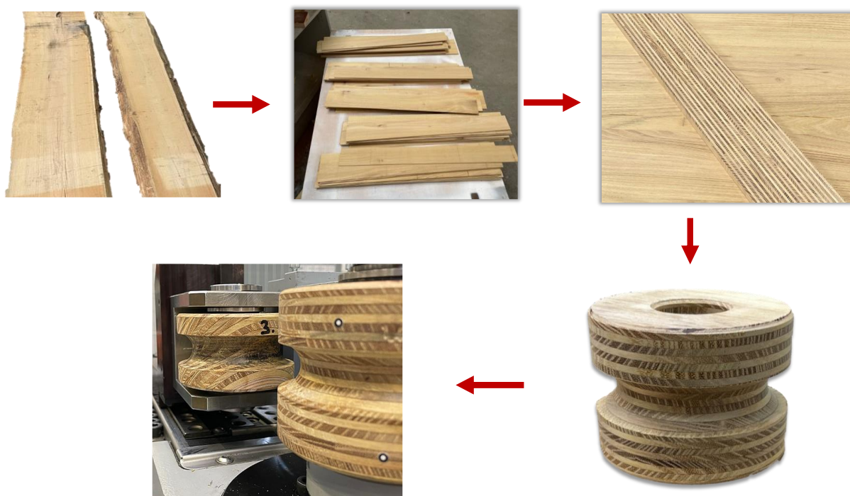
Abb. 6: Herstellungsprozess der Umformwerkzeuge als Schichtverbund aus Robinienholz
