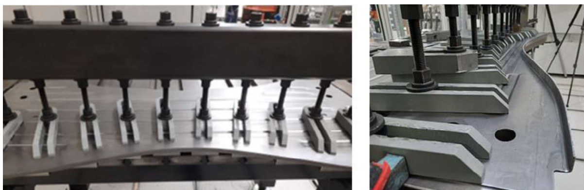
Abb. 9: Bauteil in Spannvorrichtung unmittelbar vor dem roboterbasierten Rollformen (links) sowie fertig rollgeformter Flansch (rechts)
