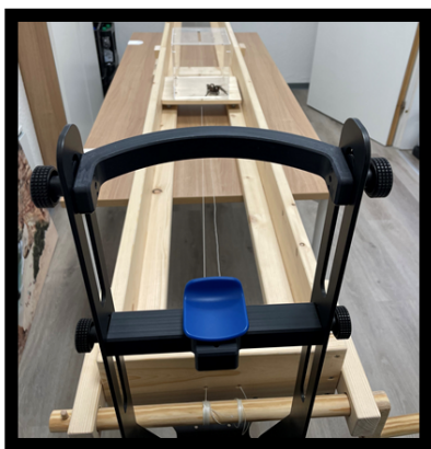
Abbildung 32: Aufbau der Kurbelkonstruktion des realen Behavioral Approach: Kinnstütze (links), Sicht des Nutzers (rechts)
