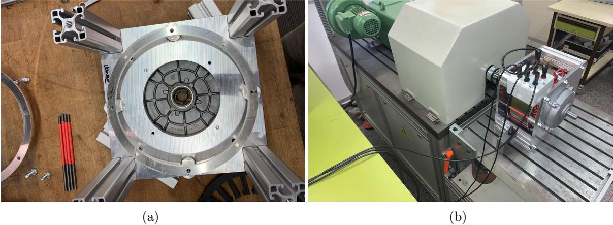
Abbildung 6.22: a) Liegender Zusammenbau der Versuchsmaschine b) Fertig gestellte Versuchsmaschine auf einem Maschinenprüfstand
