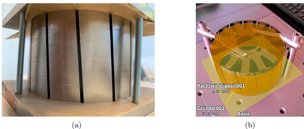
Abbildung 6.14: a) Fertig gestapeltes Rotorblechpaket eingespannt in der Hilfsapparatur b) Messergebnisse des gebackenen Rotorblechpakets
