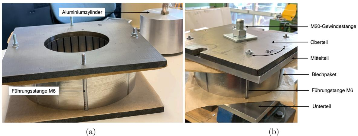
Abbildung 6.6: a) Ansicht Hilfsapparatur Unterteil, Blechpaket, Mittelteil und Aluminiumzylinder b) Komplett vorgespannte Hilfsapparatur mit Blechpaket
