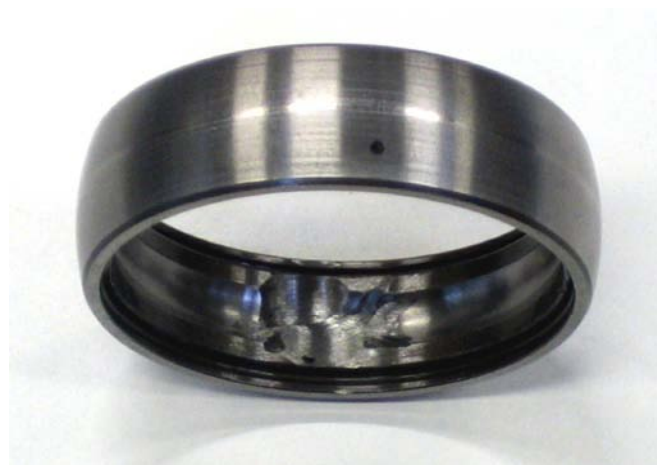
Bild 5.43: Außenringsschaden an der Lauffläche des Rings
