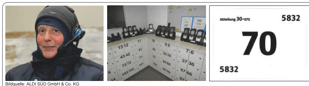
Abb. 2.4: Kältekommissioniererin mit Kopfhörer und Mikrofon eines Pick-by-Voice-Systems (links), Pick-by-Voice-Terminal in einem Warenverteilzentrum (Mitte) sowie eine Prüfkarte am Bereitstellungsort mit Lagerortnummer und Prüfziffer (rechts)
