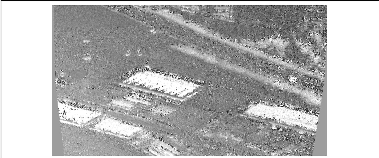
*Bild 8.4: Interferogramm nach Abzug der Phase der flachen Erde*
