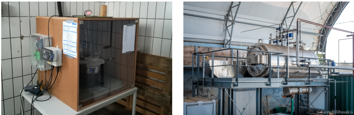
Abbildung 4.1: Verwendete Reaktoren zur Durchführung der HTC-Versuche. Links: Laborreaktor, rechts: Technikumsanlage.
