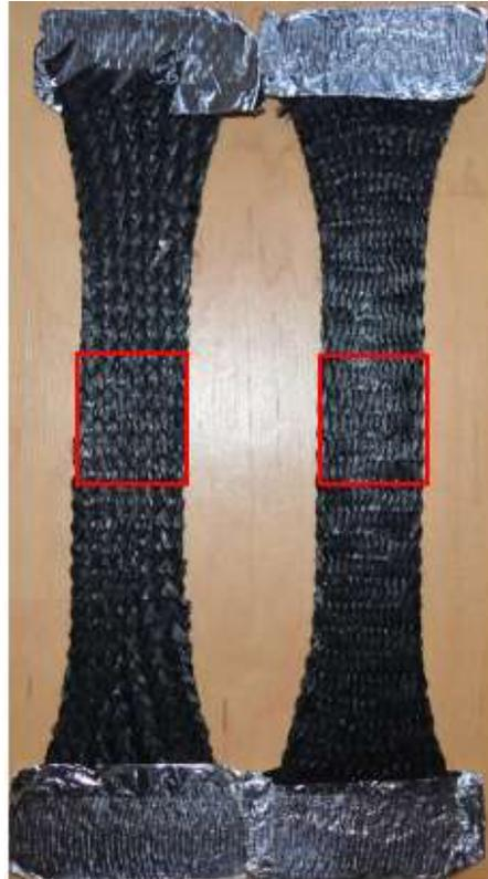
Abbildung 58: Vorderseite und Rückseite einer Probe des BET mit 3 Gewebelagen mit unterschiedlicher Drehrichtung des Scherwinkels (links: negativ; rechts: positiv) für Köpergewebe mit PP
