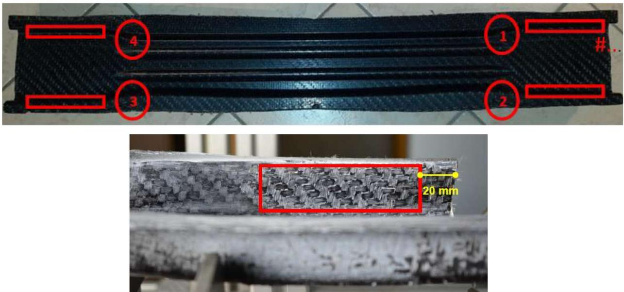
Abbildung 119: Bumperquerträger mit Bereichen maximaler Scherwinkel (rot)
