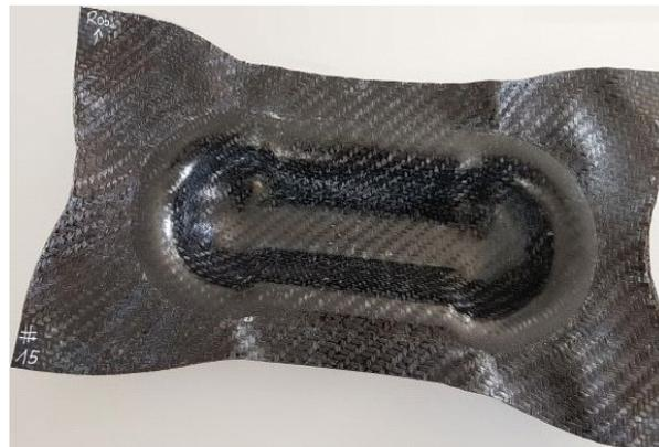
Abbildung 130: Realbauteil DoubleDome ( $260^{\circ}\text{C}$ )
