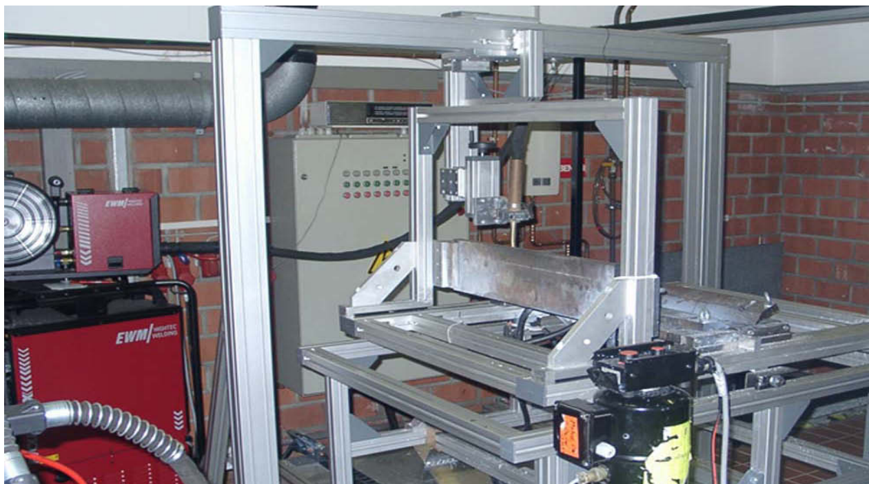
Bild 6.1: Schweißvorrichtung des Instituts für Konstruktion mit MIG-Impulsstromquelle, wassergekühltem Brenner und linear verfahrbarem Schweißtisch
