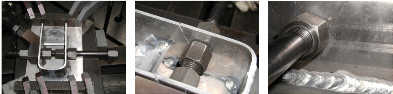
Bild 6.28: Aufbau (links) und Ergebnisse (Mitte und rechts) des Schwingversuchs mit geschraubtem Krafteinleitungsbolzen (Versuch 6)
