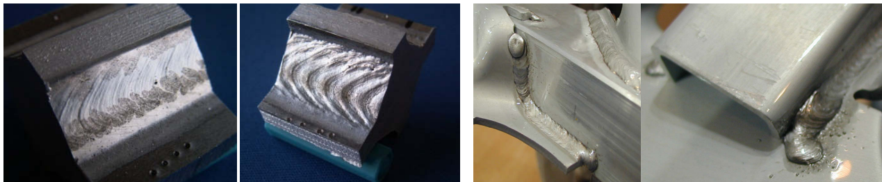
Bild 2.15: Beispiele für geometrisch nicht definierbare Geometriekerben an Schweißkonstruktionen wie unterschiedliche Schweißnahtschuppungen (links, Oberfläche einer Kehlnaht aus Al Mg 4,5 Mn 0,7 (EN AW-5083) und S Al 5183, mit unterschiedlichen Schweißparametern geschweißt) und praxisrelevante Schweißnahtverläufe (gesehen auf der Messe „Schweißen und Schneiden 2005“)
