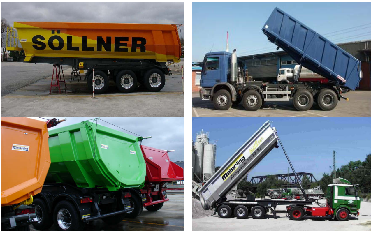
Bild 3.1: Dreiachsiger Muldenkipper in Ganzaluminiumbauweise der Fa. MEIERLING GmbH & Co. KG mit verschiedenen Ausführungen der Kippmulde (links), Grundformen für Kippaufbauten als Dreiseitenkipper (rechts oben nach [Koewius et al. 1990]) und als Muldenkipper mit Hinterkipppaufbau (rechts unten nach [Meierling 2008])
