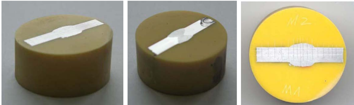
Bild 9.14: Probenpräparation für die Gefüge- und Härteuntersuchung, nach dem Polieren (links), nach dem Ätzen (Mitte) sowie Markierungen für die Härtemessung (rechts)
