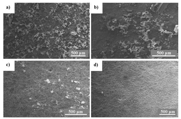
Figure 4.13: Specimen surface after: a) 0 min, b) 20 min, c) 40 min, d) 70 min of pickling
